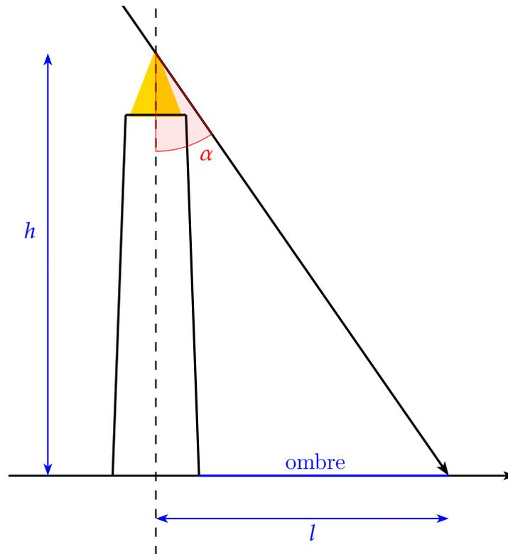
L'angle  $\alpha$  que fait un rayon du Soleil avec la verticale peut être calculé au moyen des formules de trigonométrie dans le triangle rectangle :
